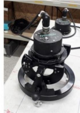
Bascule - test des accéléromètres
